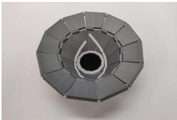
**Abb. 7b:** Durch die Magnete und das Scharnier lässt sich das ebene Modell zu einem Trichter zusammenfügen.
