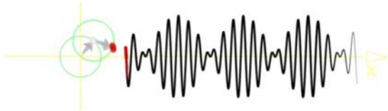
Abb. 2: Die Schwebung wird von zwei rotierenden Zeigern mit leicht verschobener Rotationsfrequenz erzeugt.
