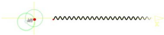
Abb. 3: Destruktive Interferenz: Zwei Zeiger rotieren mit derselben Frequenz, die Phasendifferenz \Delta\varphi \equiv \varphi_1 - \varphi_2 ist nahe 180^\circ bei zeitlich konstanter Intensität.
