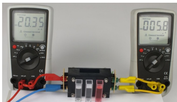
Abb. 9: Die Küvetten (im Bild noch außerhalb der Spektrometerapparatur stehend) werden in der Apparatur von links mit dem Licht einer LED durchstrahlt. Die Absorption durch die rote Farbstofflösung bei verschiedenen Konzentrationen zeigt sich in der Stromstärke an der Fotodiode.
