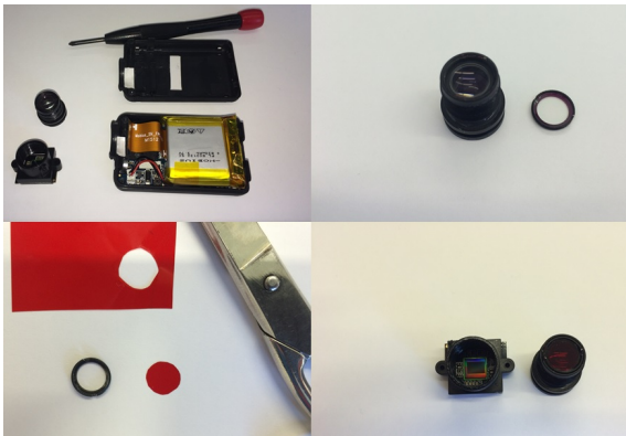
Abb. 7: Umbau der Mobius-Kamera. Nach dem Entfernen des IR-Filters (im kreisrunden Ring), wird dieser durch den roten Tiefpassfilter ersetzt.
