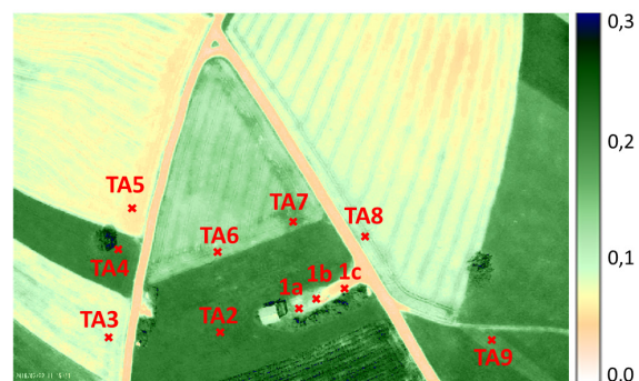
Abb. 9: NDVI-Falschfarbenbild einer Aufnahme mit der modifizierten Mobius-Kamera. Zur Validierung der Messwerte wurden Geländepunkte (Targets, rote Kreuze) mit unterschiedlichen NDVI-Werten ausgewählt.
