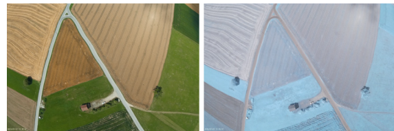
Abb. 8: Aufnahme einer landwirtschaftlichen Fläche aus 200 m Höhe mit einer handelsüblichen (links) und mit einer IR-modifizierten Mobius-Digitalkamera (rechts).
