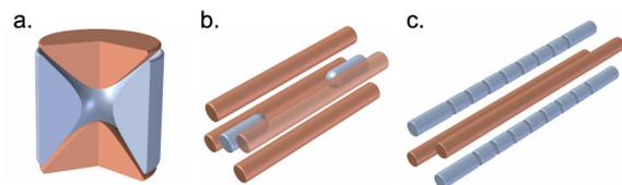
**Abb.1:** Evolution der Paulfallen: Paulfalle mit hyperbolischen Elektroden (a), lineare Paulfalle mit Endkappen (b) und lineare Paulfalle mit segmentierten Elektroden (c) bestehend aus Gleich- (blau) und Wechselspannungselektroden (braun).
