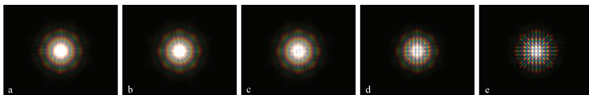
Abb. 6: Mit dem Übergang von Dia 1 zu Dia 11 tritt in der Erscheinung des Kranzes das Beugungsbild zunehmend kontrastiert auf (hier: Kreiselement). Dem Beugungsbild (a) entspricht Dia 1, (b) Dia 3, (c) Dia 6, (d) Dia 9 und (e) Dia 11.
